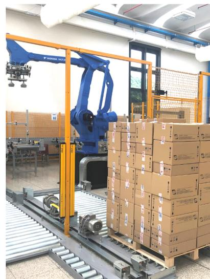
La testa del robot è stata modificata meccanicamente per ridurre gli ingombri e permettere il deposito in sicurezza di tutti i cartoni. Il **nuovo algoritmo** ha così permesso di comporre bancali con scatole di **diversi formati**.
